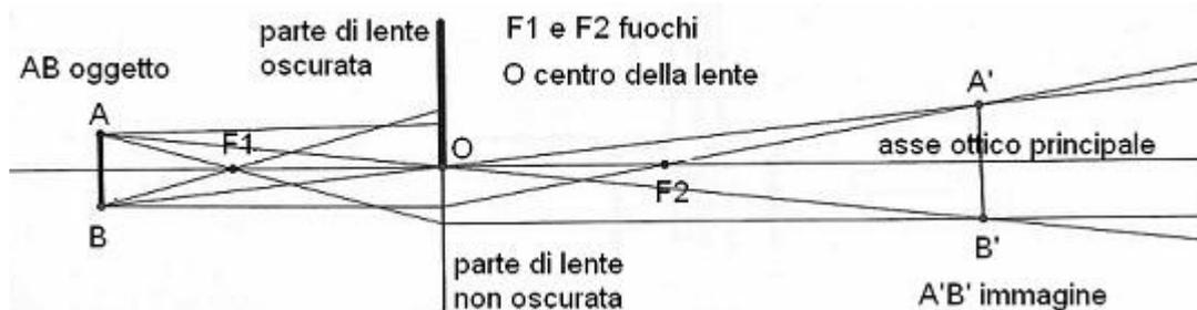
Nella figura sono evidenziati solo i raggi che, provenendo da A e da B, passano per i fuochi F1 e F2 della lente e per il suo centro O concorrendo a formare le immagini dei punti in A' e B'.
